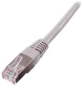
Ce cordon de brassage,de longueur standard,permet de connecter vos équipements réseau à votre panneau de brassage ainsi que vos ordinateurs à la prise réseau. Il est équipé d'un double blindage pour limiter les interférences et de contacts dorés qui le protègent de l'oxydation. Sa gaine LSZH limite les émanations de fumée toxique en cas d'incendie.
