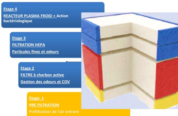
L'air de la pièce est aspiré par le bas de l'appareil MULTIZONE DOPAIR®, passe par plusieurs étapes de décontamination et est ressoufflé dans la salle à 360° par le haut de l'appareil MULTIZONE DOPAIR®.
