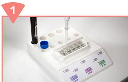
Mélanger 5 $\mu$ L d'échantillon sanguin et 500 $\mu$ L de solution de coloration et charger 35 $\mu$ L du mélange sur les lames fournies.
