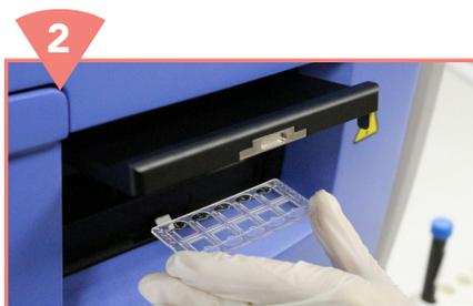
Insérer les lames à usage unique dans le CELLSCHECK.
