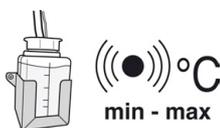
Senseur extra dans bouteille témoin pour alarme température
