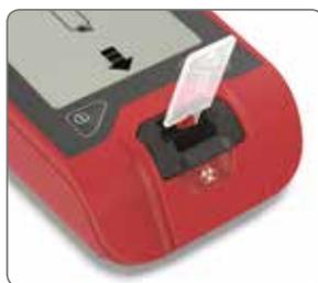
2 Placez la microcuvette dans l'analyseur.
