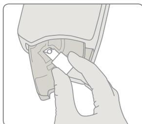
2 Placez la microcuvette dans l'analyseur.
