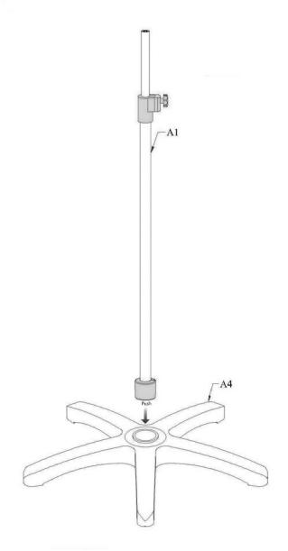
Assurez-vous que la bague en plastique est positionnée sur le tube, et non dans le pieds
