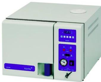
La chaleur et l'humidité provoquent l'élimination des germes : c'est donc la vapeur d'eau saturée sous pression qui permet la stérilisation. Pour une stérilisation efficace, il faut respecter quelques règles élémentaires :
